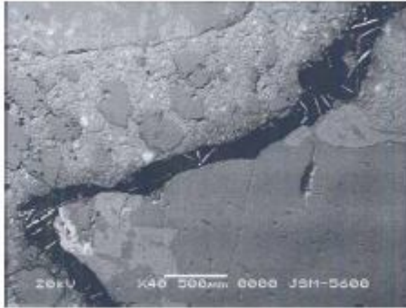
21. Ábra: A repedésben létrejövő Penetron kristályok visszaszórt elektronfelvétele (BEI) 7
