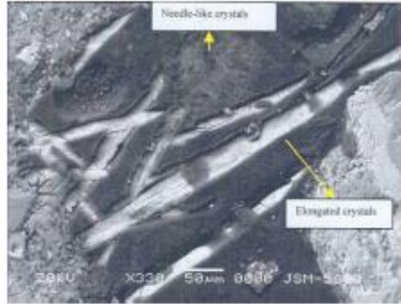
22. Ábra: A Penetron túszerű, megnyúlt alakzatai a repedésekben
